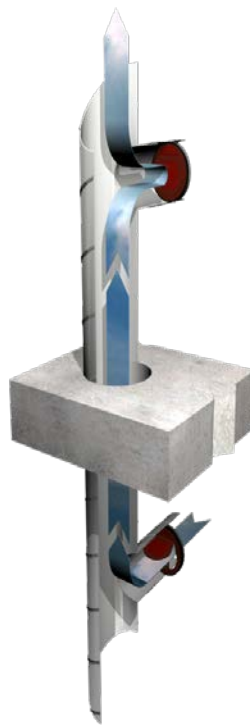
Abbildung 1 Funktionsweise Kaltrauchsperrern (Fa. Air-Fire-Tech)
